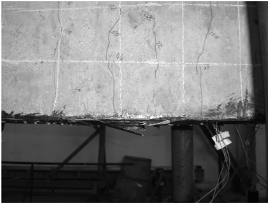
图 5 L2 破坏时碳纤维布的状态
