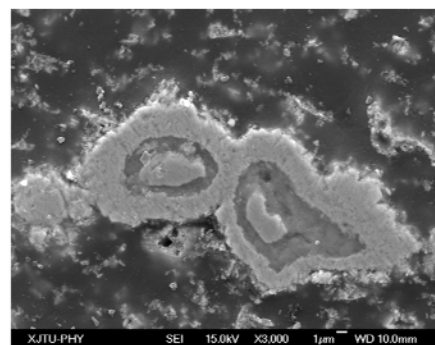
图4 包覆后铁氧体剖面的 SEM 图片
