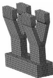
图 2 Y型桥墩局部单元网格划分
