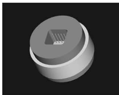
图1 真空电阻凸焊夹具及工件示意图
