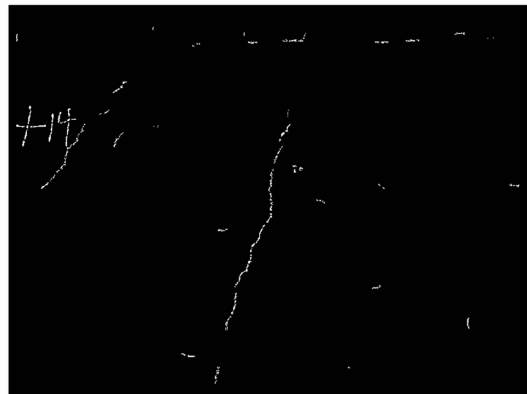
(d) 去模糊后提取的桥梁病害
