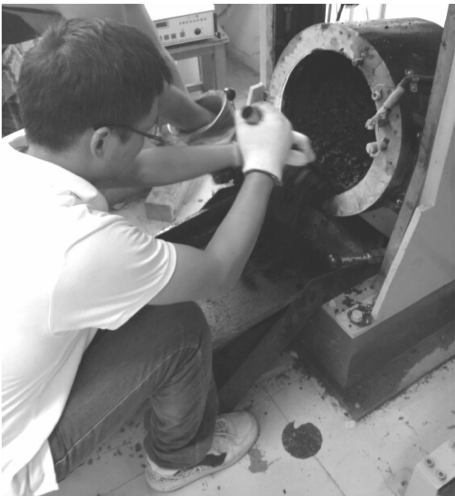
图 1 热拌沥青混合料的拌和
