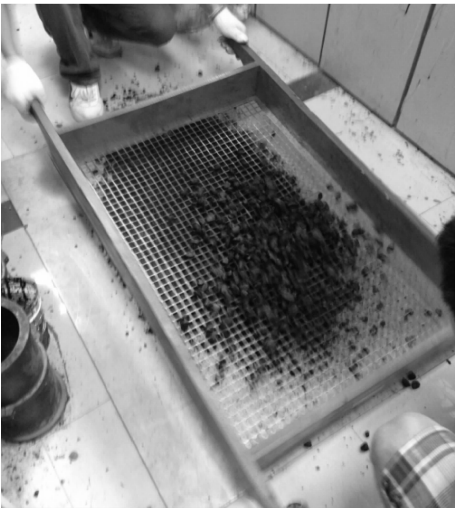
图 2 热拌沥青混合料的筛分
