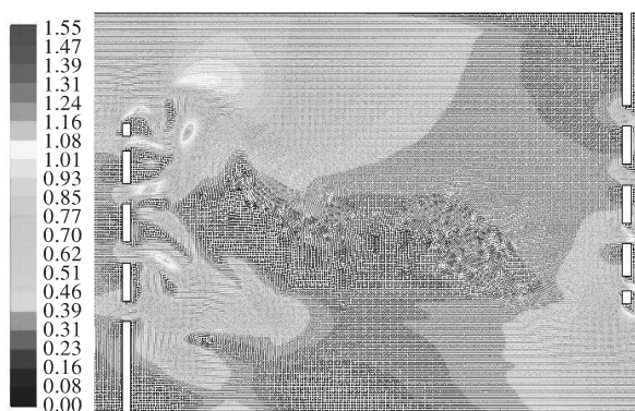
图4 壳程入口流速为0.8 m/s时开圆孔折流板背部速度云图
