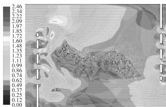
图6 壳程入口流速为1.3 m/s时开圆孔折流板背部速度云图
