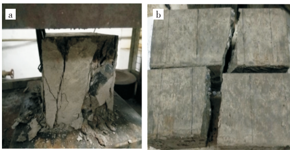
图5 普通混凝土破坏形态:(a)立方体抗压,(b)抗折
